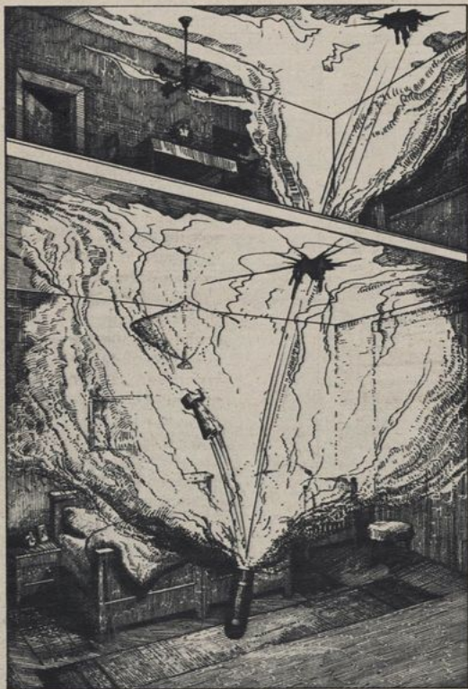
Fosforová zápalná puma 14 kg prorazi niekoľik poschodí a vystřikuje přitom za sebou 3—4 litry zápalné hmoty. V prvých vteřinách vzplanou silné plameny a vyvíjí se dým. Všechny proražené místnosti jsou zasaženy.
